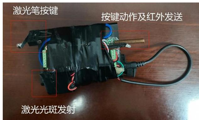
图 3-3 激光光斑发射器
